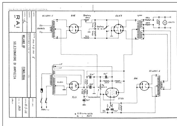
Figure 1. Original project scheme of the Selezionatore di Ampiezza.
